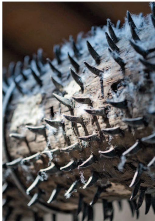
Bild 3: Diese hölzernen Walzen des Krempelwolfes, die die Wolle auseinander reißen, mussten für den Vorführbetrieb erneuert werden, weil die Reißzähne in dem Holz keinen sicheren Stand mehr hatten. Diese Walze hängt über dem Wolf zur Ansicht und verdeutlicht den Austauschprozess für die Museumsgäste. (© LVR-Industriemuseum; Foto: Helmut Dahmen)
